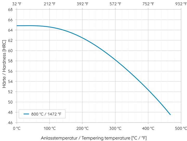
Probenquerschnitt: Vkt. 20 mm
